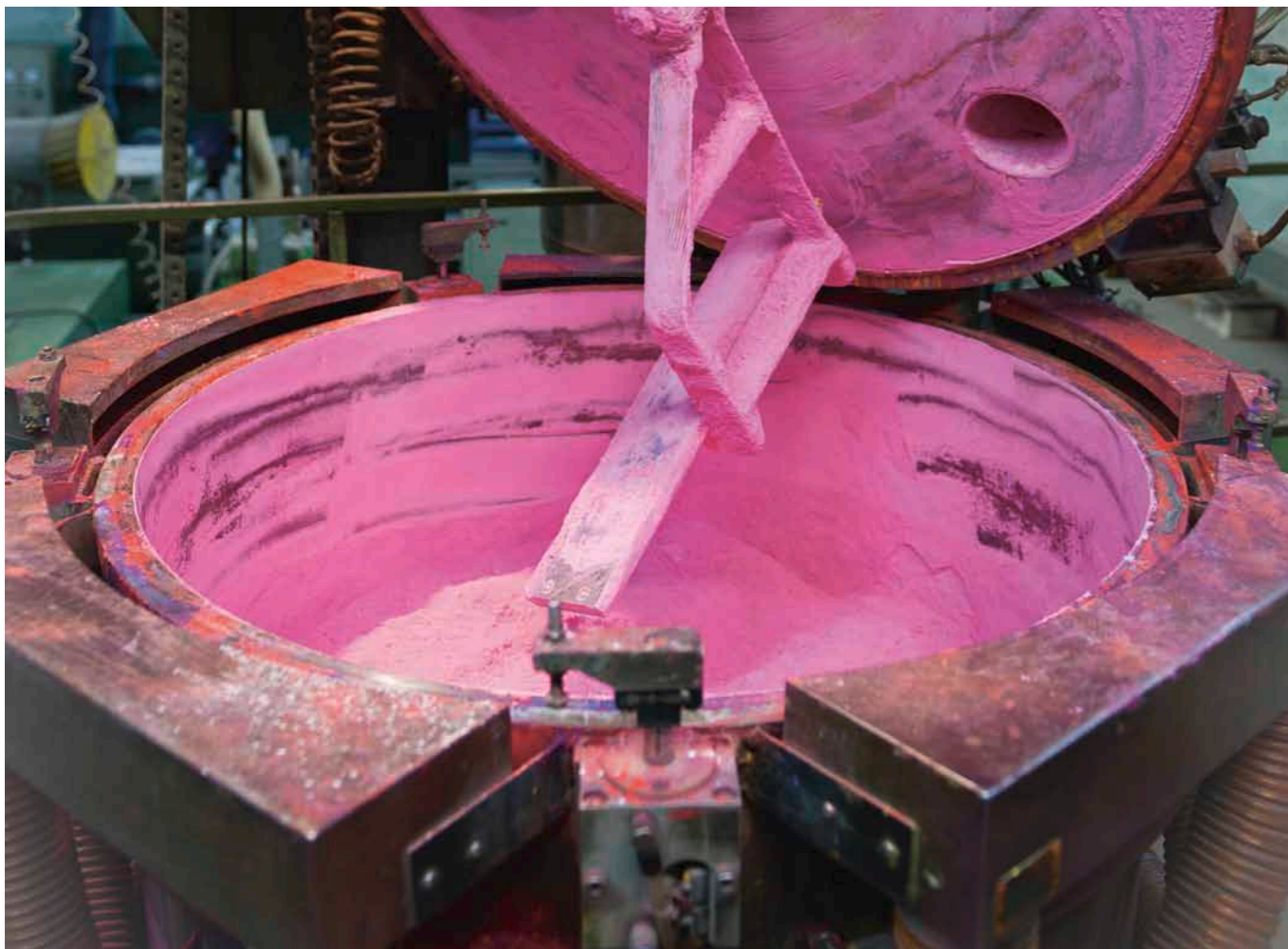
In der «Kaffeemaschine» werden Farbpigmente und Füllstoffe vermischt.
